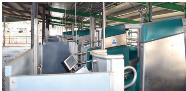
Las vacas se llevan por lotes a la sala de espera y van entrando solas a los 8 DairyRobots R9500 colocados en batería
