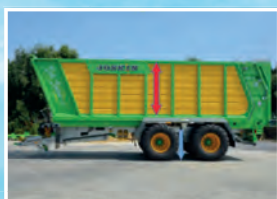
Bastidor autoportante, baja el centro de gravedad para una mejor estabilidad
