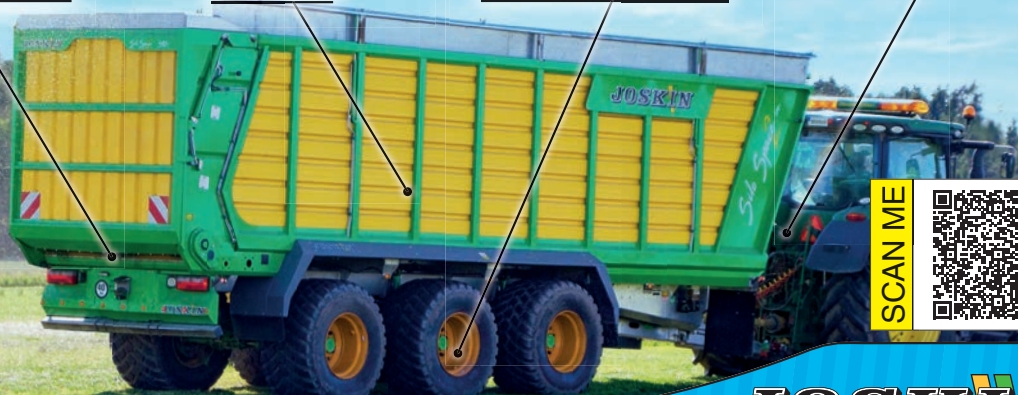
Bastidor autoportante, baja el centro de gravedad para una mejor estabilidad
