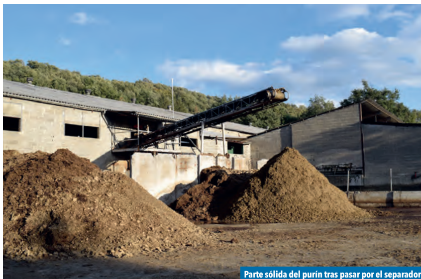
Parte sólida del purín tras pasar por el separador
