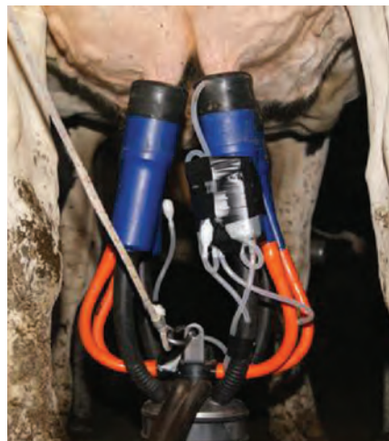
Figura 8. Realización del test de tiempo de ordeño con un sensor de cuatro canales colocado en la unidad
