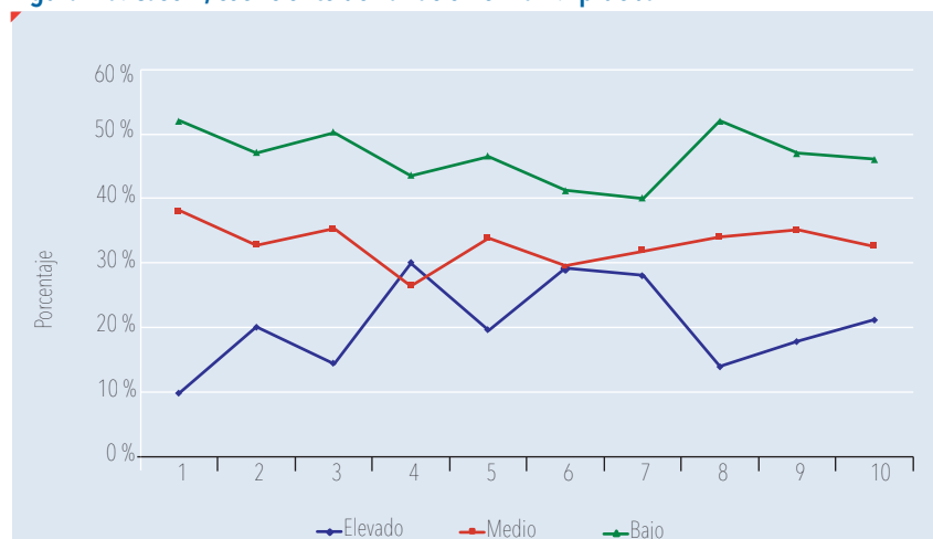
Figura 7 b. Caso 1, coeficiente de variación en la 2.ª prueba tras los cambios aconsejados
