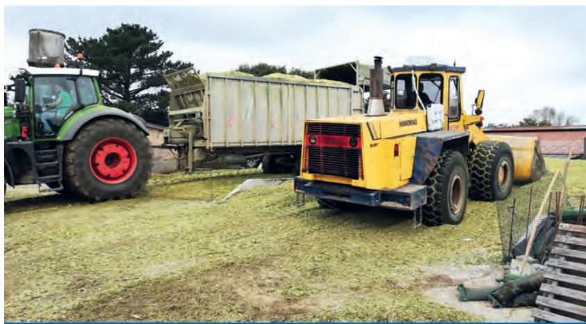
Para equilibrar el rendimiento de la compactación con el de la picadora, debemos aumentar el peso de los tractores, así como la presión de los neumáticos
