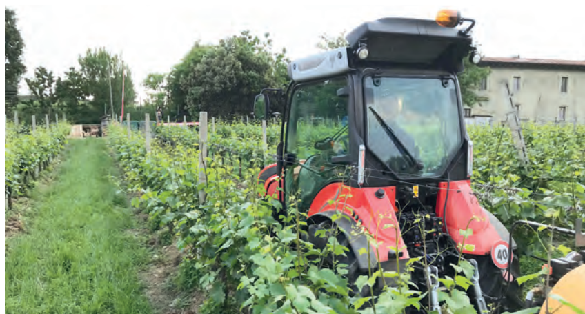
Os tractores viñateiros son especialmente estreitos e en ocasións non de todo cómodos para o condutor, aínda que os fabricantes están a ofrecer solucións neste sentido
