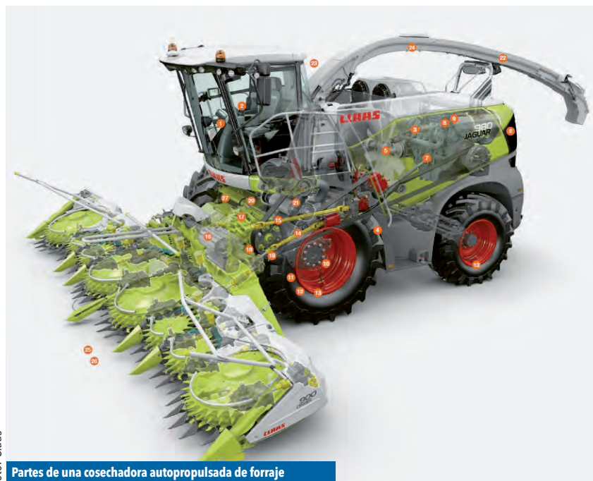
Partes de una cosechadora autopropulsada de forraje
