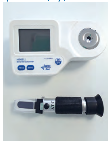
Figura 5. Refractómetros digital (arriba) y óptico o manual (abajo)
