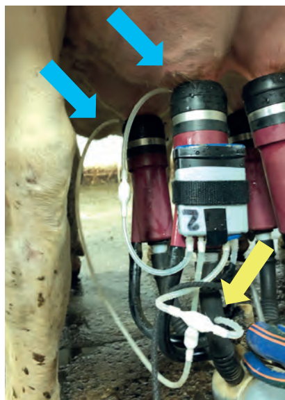
Imagen 1. Medidor de vacío digital VaDia conectado a una unidad de ordeño a través de pequeños tubos de plástico en tres lugares: boca de la pezonera delantera izquierda y trasera izquierda (flechas azules) y tubo corto de leche (flecha amarilla)
