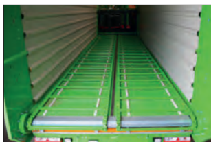
• Cinta transportadora con doble accionamiento hidráulico y con 2 velocidades
