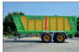
• Bastidor autoportante, baja el centro de gravedad para una mejor estabilidad
