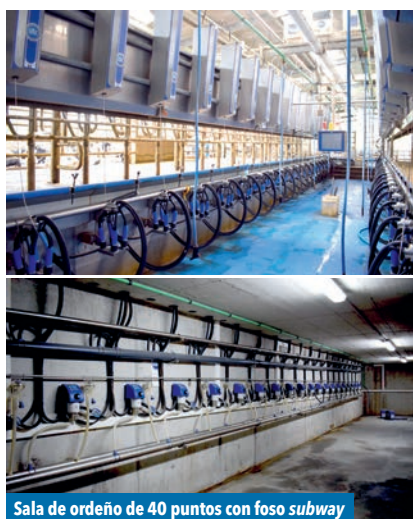
Sala de ordeño de 40 puntos con foso subway
