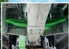
Suspensión de la barra de tiro por láminas parabólicas
