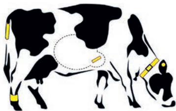
Figura 1. Principales localizaciones de dispositivos para la recogida de datos in situ en una vaca (oreja, cuello, pata, cola, rumen...)
