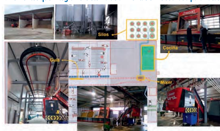
Figura 3. Las cuatro etapas de los sistemas de alimentación robotizada
