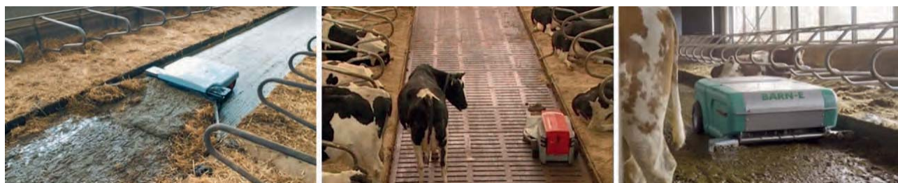
Figura 7. Las tres formas de realizar la limpieza con robots: por empuje, barrido o aspiración
