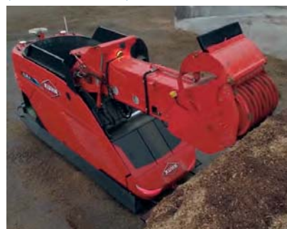
Figura 5. Mixer autopulsado autónomo (detalle de Kuhn)
