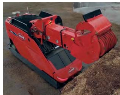
Figura 5. Mixer autopulsado autónomo (detalle de Kuhn)
