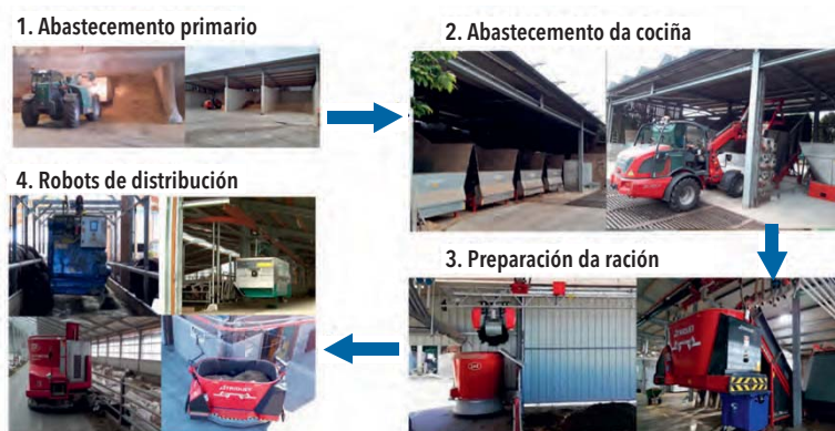
Figura 3. As catro etapas dos sistemas de alimentación robotizada
