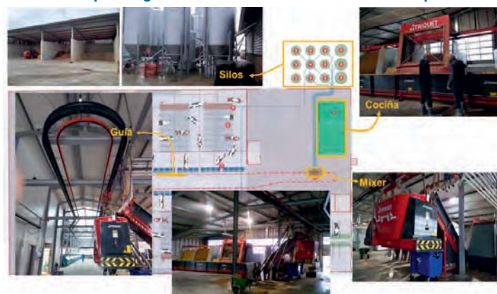
Figura 3. As catro etapas dos sistemas de alimentación robotizada
