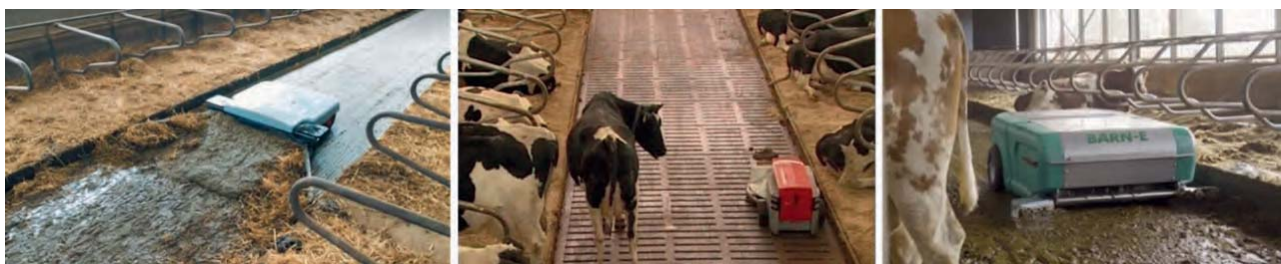
Figura 7. As tres formas de realizar a limpeza con robots: por empuxe, varrido ou aspiración
