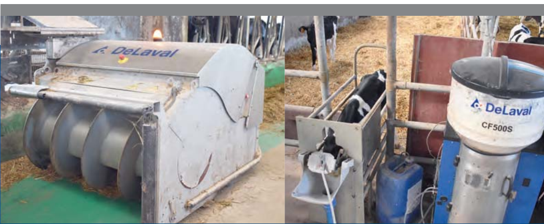
A la par con los robots de ordeño, instalaron la nodriza y el arrimador de comida de DeLaval
