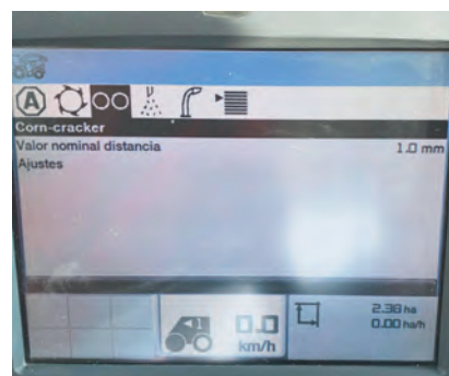
Figura 4. Ajuste en el procesador de grano para un maíz de grano chico o delgado para el que fue necesario tener una apertura de 1 mm
