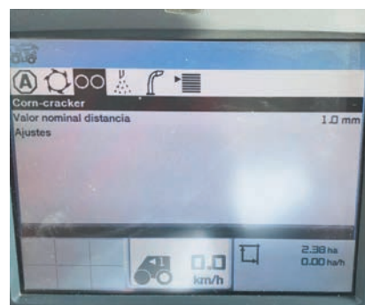
Figura 4. Axuste no procesador de gran para un millo de gran novo ou fraco para o que foi necesario ter unha apertura de 1 mm
