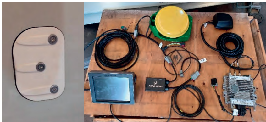
Figura 5. Sensores y equipos adicionales instalados en las cosechadoras autopropulsadas
