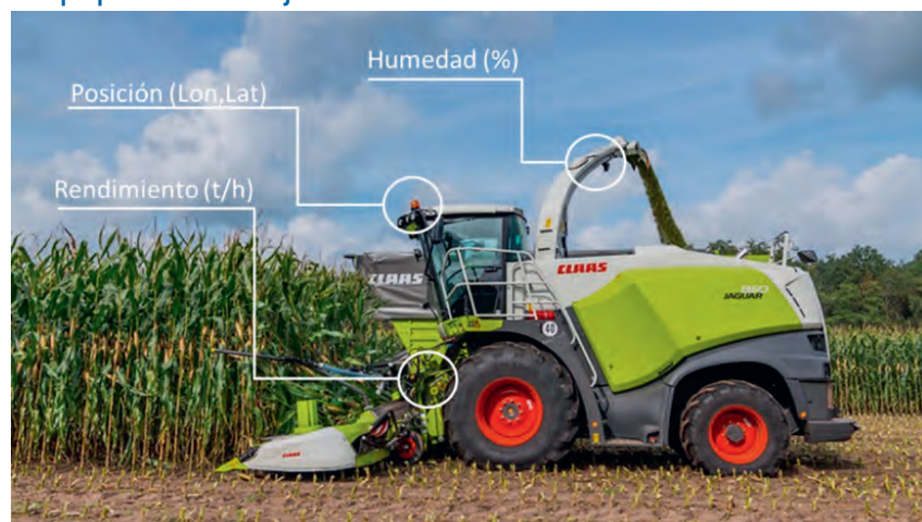
Figura 3. Sensores necesarios para obtener mapas de rendimiento en cosechadoras autopropulsadas de forraje
