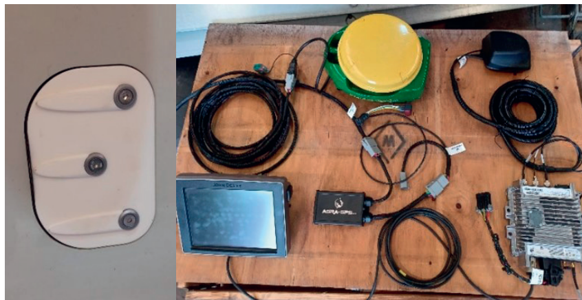
Figura 5. Sensores e equipos adicionais instalados nas recolledoras autopropulsadas
