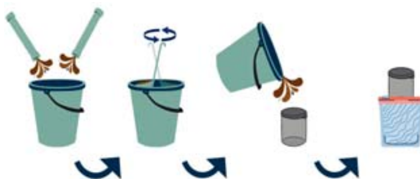
Figura 3. Las submuestras se vierten en un cubo común; luego se mezclan bien para obtener una muestra y se vierten en el envase final. Se etiqueta y se envía a laboratorio
