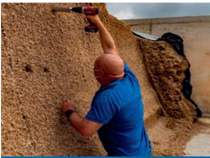
Uso do densitómetro no silo de millo
