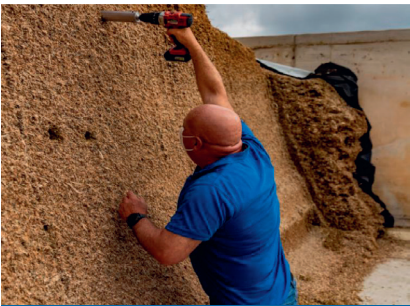
Uso del densitómetro en silo de maíz
