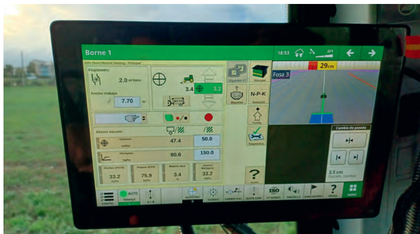
Foto 5. Monitor G5 Plus con la pantalla principal de control del NIRS HarvestLab 3000 durante una aplicación de purín
