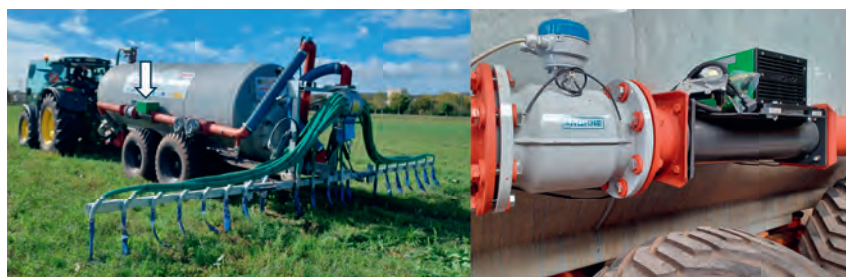
Foto 4. Equipo NIRS y caudalímetro instalados en la tubería exterior de salida del purín
