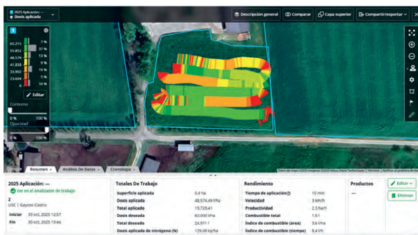
Foto 6. Documentación digital de una aplicación de purín en la aplicación en la nube del Centro de Operaciones de John Deere
