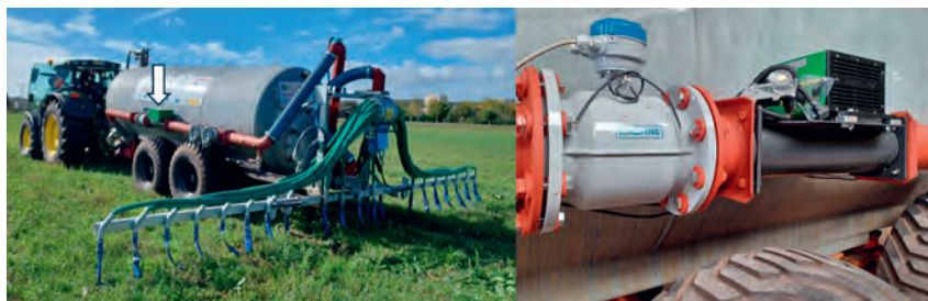
Foto 4. Equipo NIRS e caudalímetro instalados na tubaxe exterior de saída do xurro
