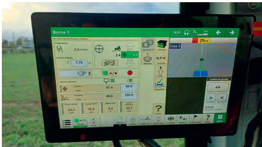
Foto 5. Monitor G5 Plus coa pantalla principal de control do NIRS HarvestLab 3000 durante unha aplicación de xurro
