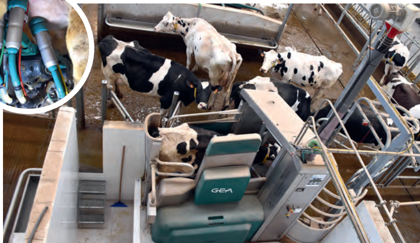
Instalaron dos robots de ordeño en tráfico libre
