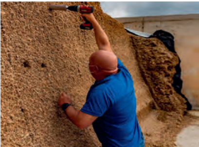
Uso do densitómetro en silo de millo
